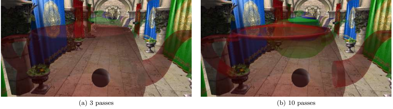
FIGURE 6 – Changement du nombre de passes sur les objets transparents avec Depth peeling .
